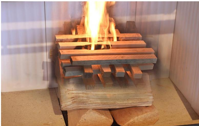
Beim „Feuer von oben“ strömen die entstehenden Gase direkt durch die heißen Flammen und werden so vollständig verbrannt
